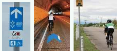
案内サイン(支柱の看板設置) 矢羽根型路面表示(トンネル内の側) 注意喚起看板(幅員の狭い路線)
